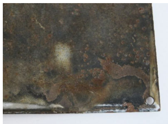
4. ábra Vaskorróziós termékek megjelenése a tárgy hátoldalán
