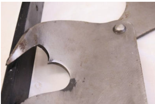
5. ábra A megtisztított tárgy sérült felületei passzíválás után
