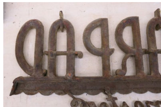
6. ábra A hátoldalt nem festették színesre, helyette korrózió elleni védőfestékkel vonták be, már nem fejti ki hatását
