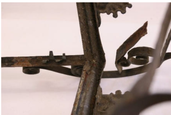
4. ábra A tárgy belső ívien kialakult korrózió és
