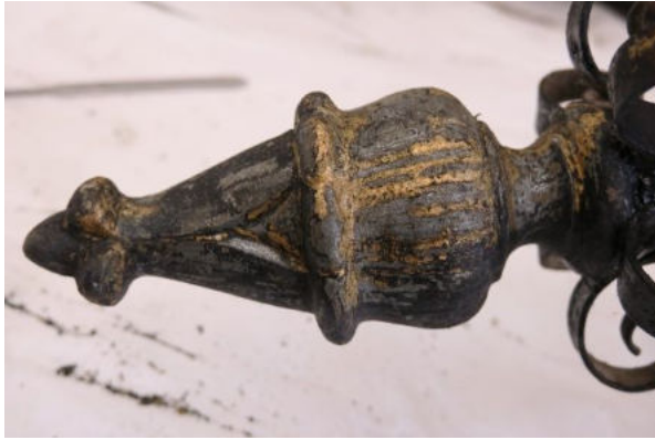
6. ábra Az átfestés alól előtűnő egykori „aranyozás” nyomai
