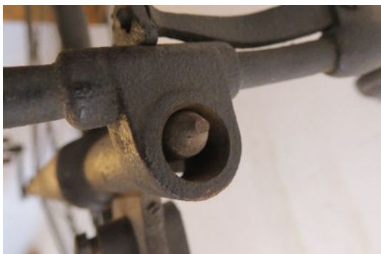
5. ábra A velocipéd első és hátsó elemének összeillesztése a kormánynál
