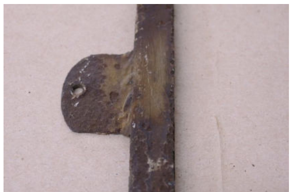
6. ábra Az egykori festék lepergése a korrózió által
