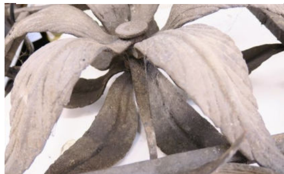
3. ábra Poros szennyeződés és előregedett bevonat a tárgy felületén
