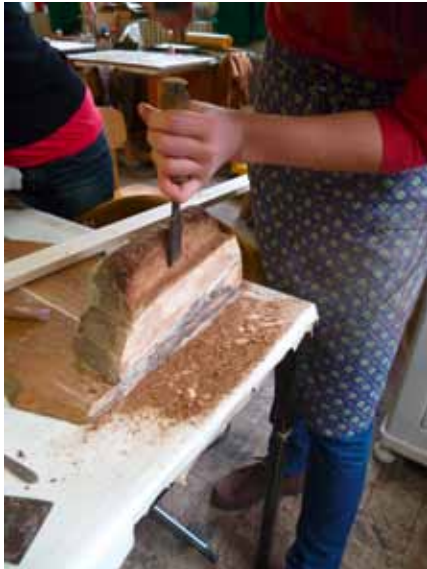
14. kép. Az angyal roncsolódott részeinek eltávolítása. (A szerző fotója)
